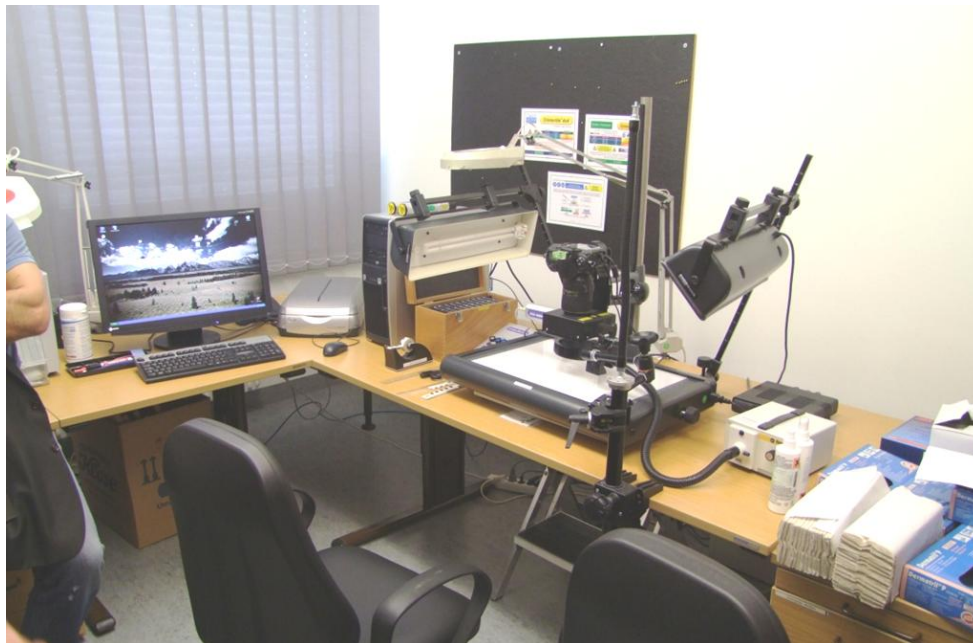
Ryc.4 Stanowisko do fotograficznego utrwalania śladów daktyloskopijnych w skali 1:1
