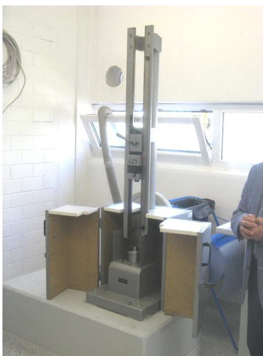
Ryc. 14 Urządzenie służące do oceny wybuchowości nn substancji
