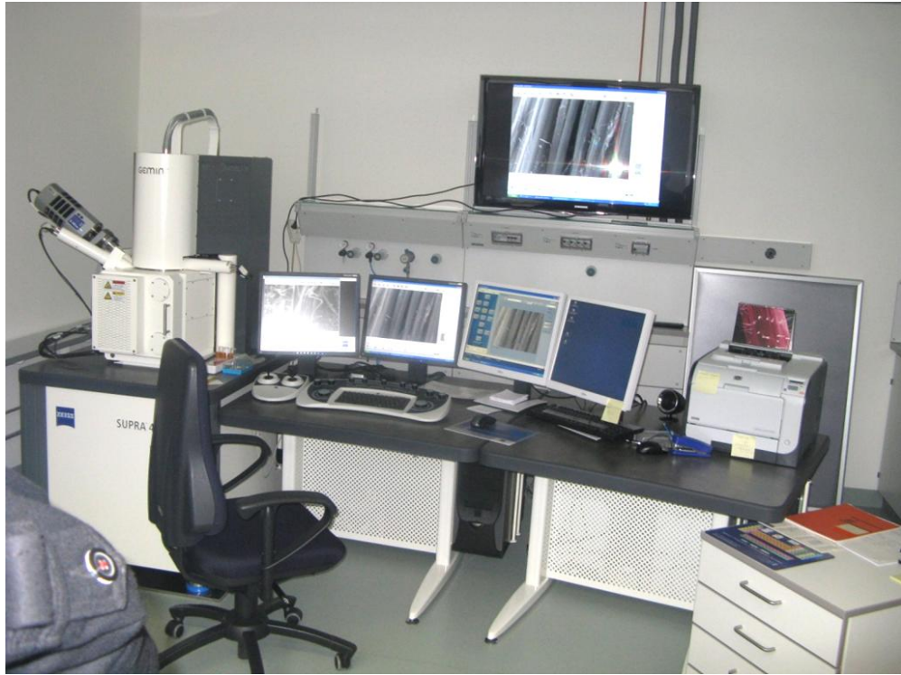
Ryc.7 Stanowisko do pracy z mikroskopem elektronowym
