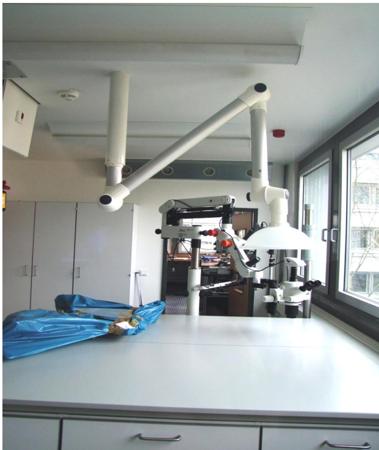
Ryc.11 Stół oględzinowy z mikroskopem stereoskopowym na wysięgniku i wyciągiem punktowym
